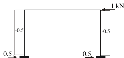
Abb. 6.5 Ersatzsystem mit exakten Querkraftverlauf in den Stielen
